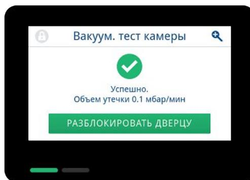
6. Если интенсивность утечки превышает 1,3 мбар, на дисплее появится соответствующее сообщение. Оба светодиода загорятся красным цветом. Повторите вакуумный тест, после того как стерилизационная камера вновь остынет, или обратитесь к уполномоченному техническому специалисту.
