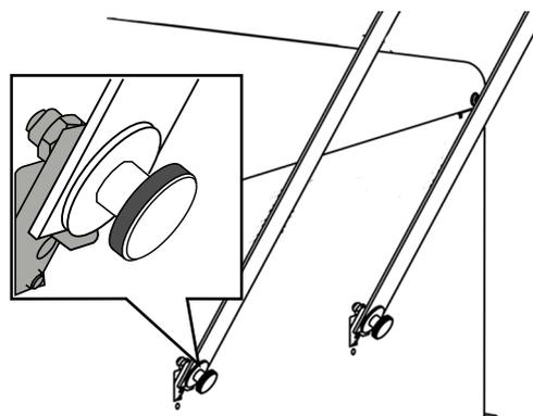
5. Закройте заглушками отверстия, предназначенные для системы крепления.
