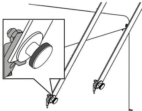
3. Закрепите их на устройстве с помощью четырех винтов с накатанной головкой.
