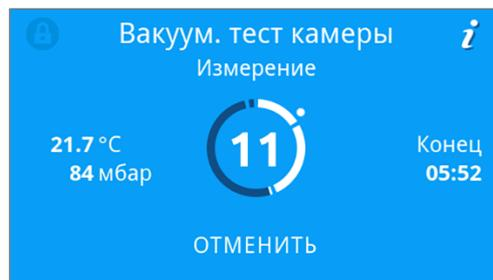
5. По истечении времени измерения в стерилизационную камеру подаётся воздух. Затем на дисплее появляется сообщение с указанием интенсивности утечки. После успешного завершения программы светодиодный индикатор состояния устройства (левый светодиод) загорается зелёным цветом, и раздается звуковой сигнал.
