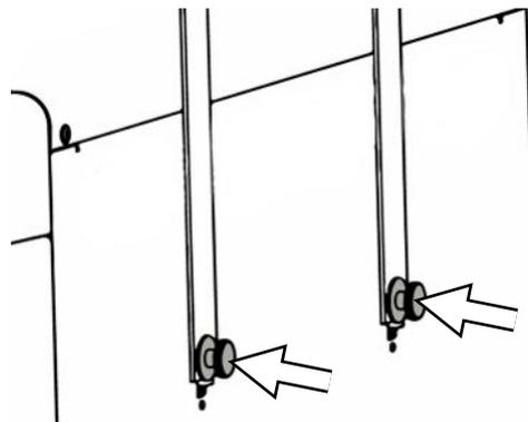
4. Извлеките систему крепления из отверстий устройства и отцепите ремни для переноски от боковой стенки.
