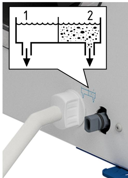
4. Поверните сливной клапан со сливной трубкой против часовой стрелки до упора.
