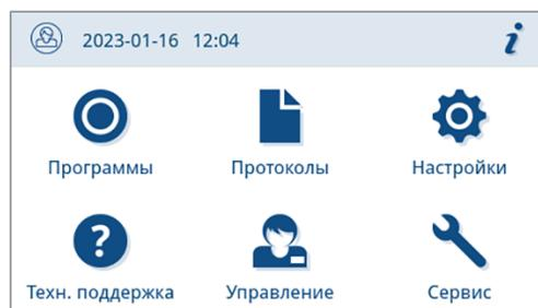
2. Выберите тип протокола с целью просмотра и вывода отдельных или нескольких протоколов одного типа. Чтобы вывести все протоколы программы/неполадок/состояния, хранящиеся в устройстве, используйте функцию **Экспортир. все** в меню протоколов.
