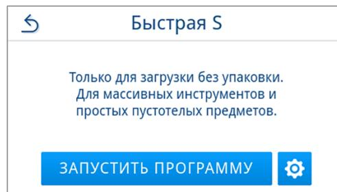
→ При запуске программы устройство проверяет количество питательной воды и её проводимость.
