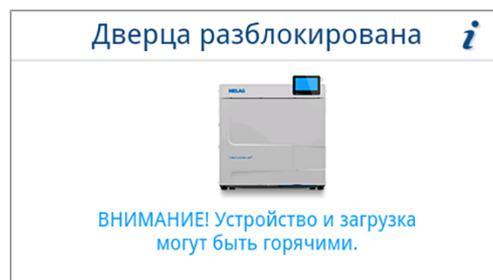
Если в меню **Настройки** активирован автоматический вывод протокола по завершении программы (= немедленный вывод), то после открытия дверцы протокол выполненной программы будет выведен на активированные устройства для вывода данных.
